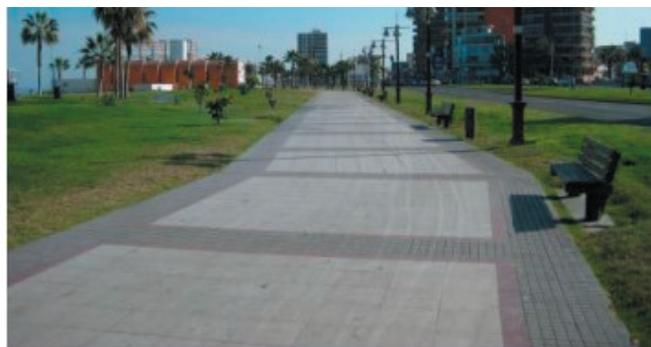
Fig 1: Ruta accesible, circulación continua de 1,2m a 2,0m mínimo de ancho (dependiendo del tipo de vía que enfrenta) por 2,1m de alto libre de obstáculos y gradas.
