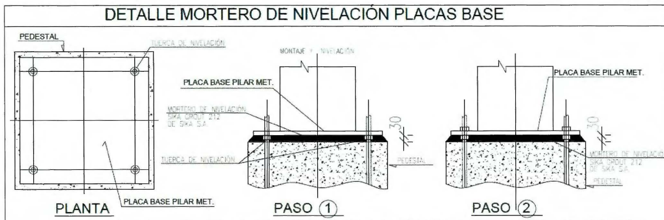
Imagen N° 6: Detalle mortero de nivelación placa base
