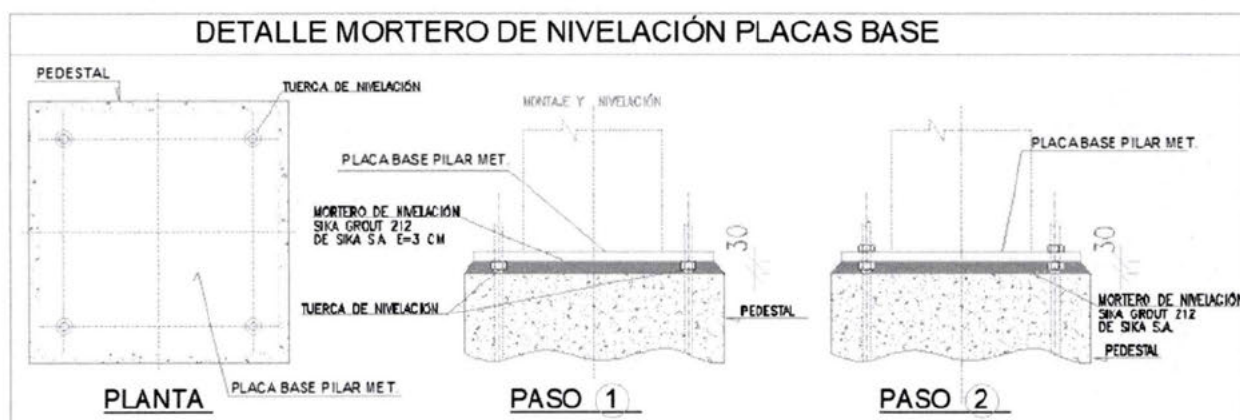
Imagen N°7: Detalle Nivelación Placa Base
