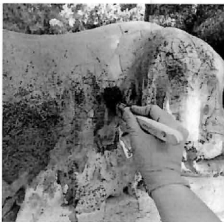
Aplicación de silicato de etilo sobre la superficie de la pieza.
