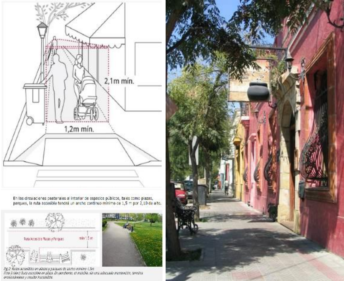
Dimensiones mínimas para la Ruta Accesible (izquierda); Ruta accesible en calle Manuel Montt (derecha)
