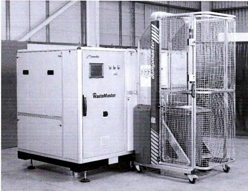
Ilustración 4 ( Maquina WasteMaster con cubo posicionado para carga a la espera de comenzar el proceso pulsando el botón de carga)
