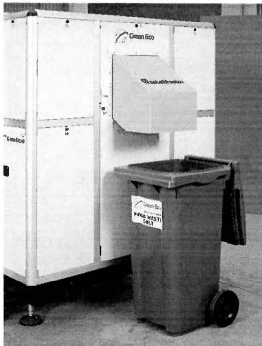
*Ilustración 3 ( detalle de la tobera de salida de producto y un cubo de 120l colocado a la espera de decepcionar automáticamente el producto. Cabe remarcar que en el caso de providencia la maquina está adaptada para poder posicionar cubos de 1100 litros)*
