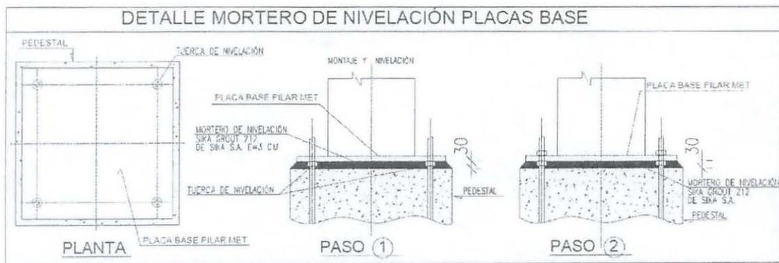
Imagen 11 Detalle Nivelación Placa Base
