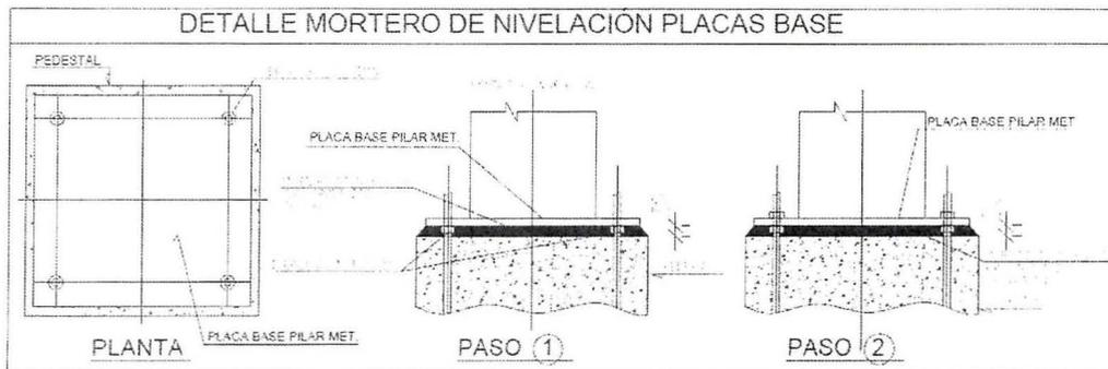
Imagen N°6 Detalle nivelación Placa Base
