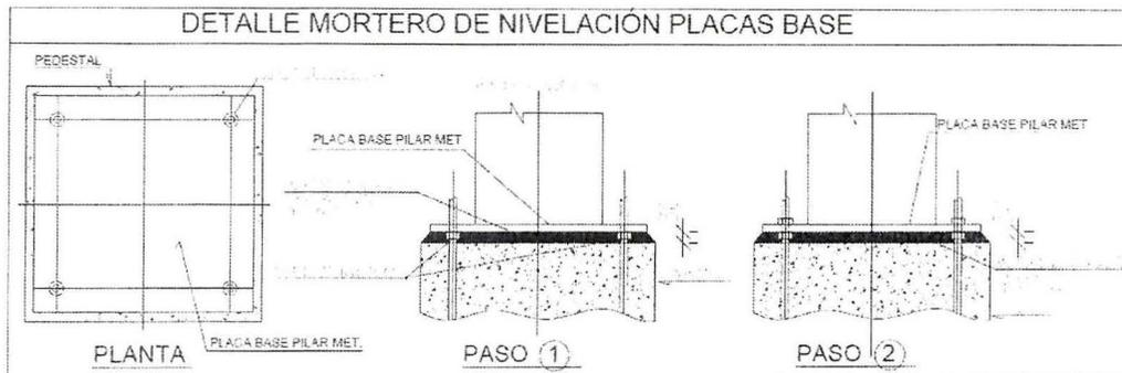
Imagen N°8 Detalle nivelación Placa Base
