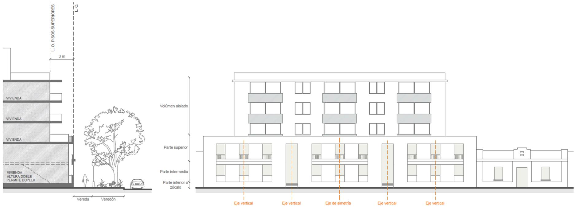
Figura 103. Corte y elevación. Configuración de la fachada zona de edificación E5 (C+A), edificio de vivienda.
