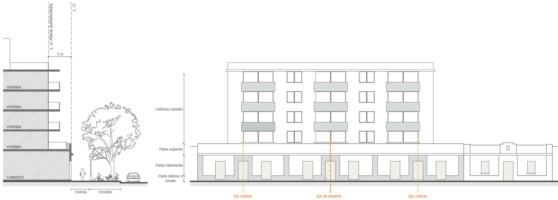
Figura 101. Corte y elevación. Configuración de la fachada zona de edificación E5 (C+A), edificio con comercio en primer piso y vivienda en pisos superiores.
