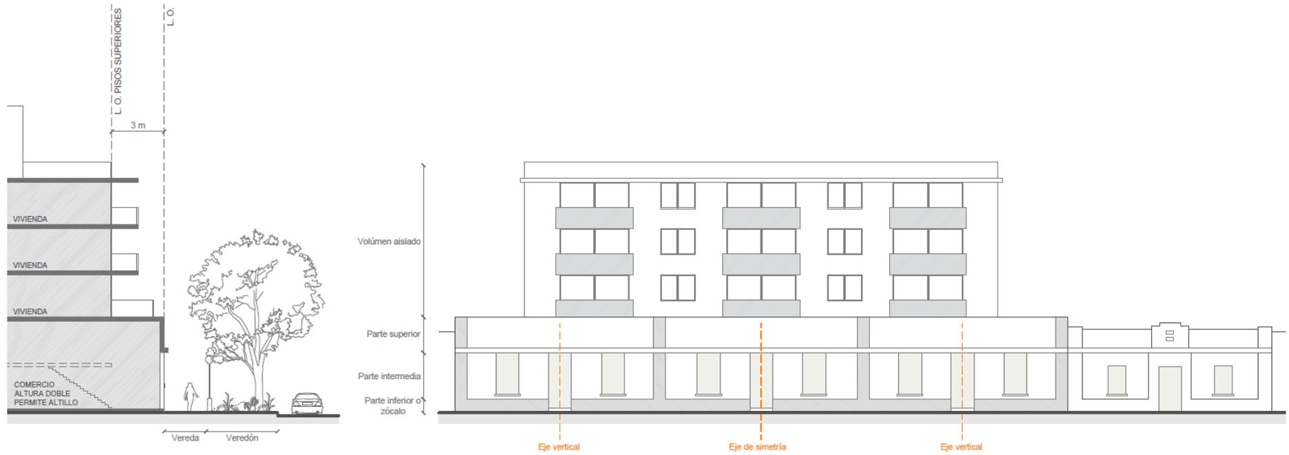
Figura 102. Corte y elevación. Configuración de la fachada zona de edificación E5 (C+A), edificio con comercio/oficina en dos pisos y vivienda en pisos superiores.
