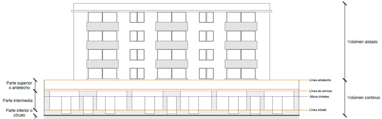
Figura 97. Esquema de partes de la edificación para la zona de edificación E5 (C+A).
