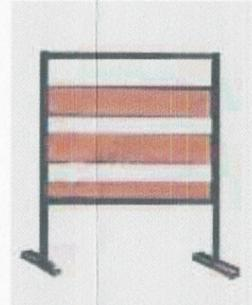
Separador tipo 2 estructura metálica y madera. 100x80 cms base 40 cms
