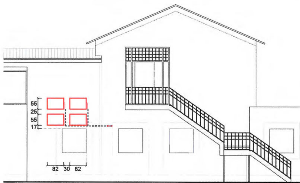
Figura 55. Ubicaciones equipos exteriores en muro sur
