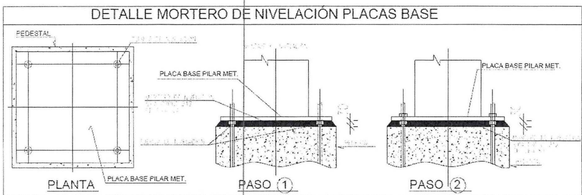
Imagen N°8 Detalle nivelación Placa Base
